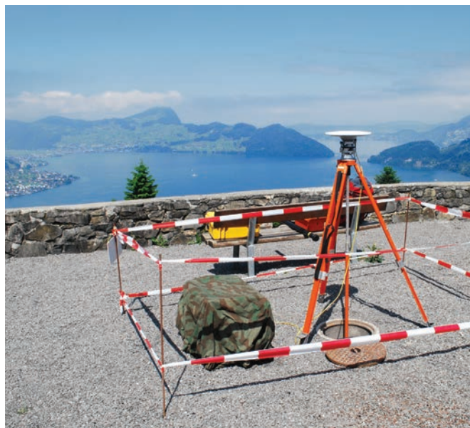
Der zum Schutz in einem Schacht versenkte Referenzpunkt der Landesvermessung wird mit moderner GPS-Ausrüstung gemessen.
